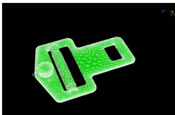
Fig.2 p-h アダプティブ法により得られた 精度の高い有限要素分割
